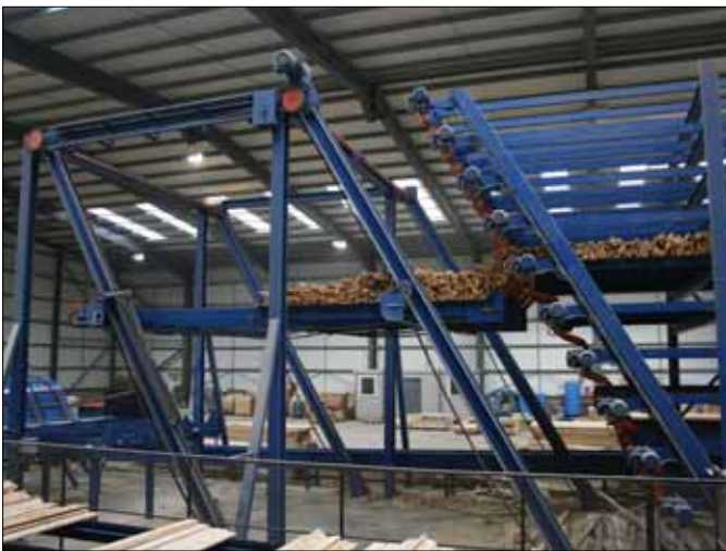
7. Entleerung von Etagen auf einen absenkba- ren Querförderer
