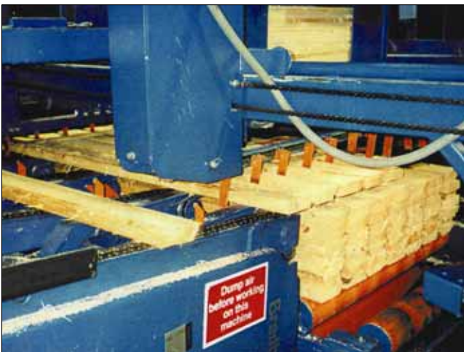
20. Lamellenstapelung, Stärke 5 mm
