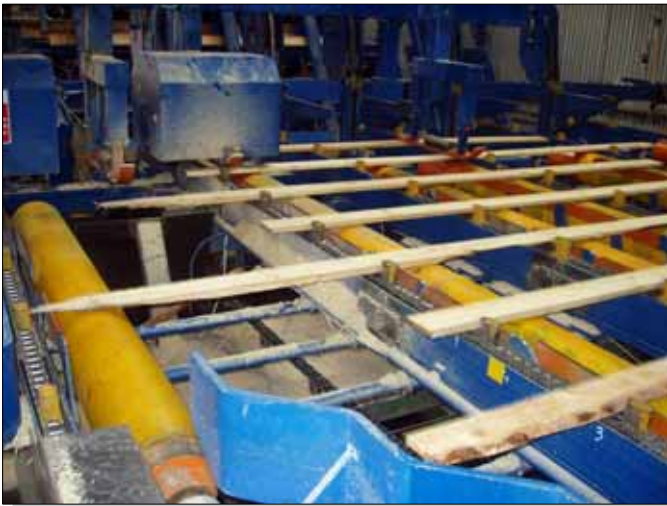
5. Trimmen und Fehlerkappung von Brettern
