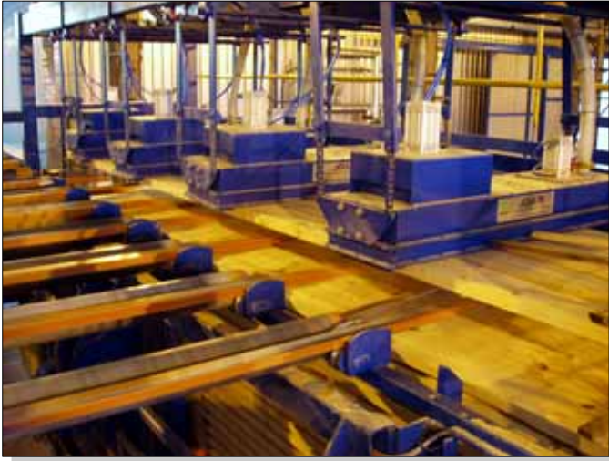
12. Vakuumentstapelung – sehr schnell mit kompletten Lagen
