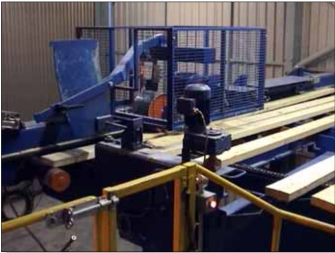
14. Einzug für Hobelmaschine oder Röntgen-scanner – bis zu 400 m/min.
