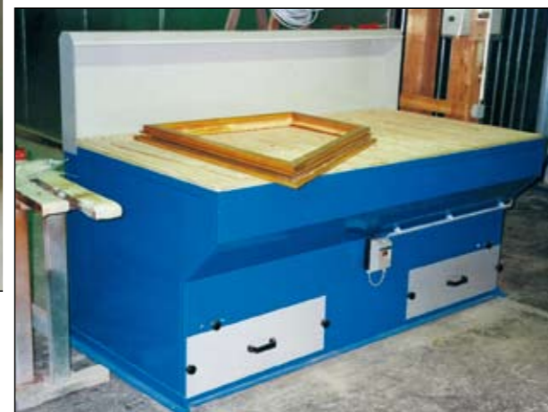
Шлифовальный стол с автономной вытяжкой и двумя фильтрами внутри стола.
